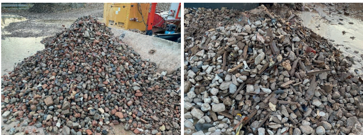
Obrázek 3) Recyklát po strojním omytí od jemných a plovoucích částic (vlevo); Plovoucí částice (odpad) po strojním omytí recyklátu (vpravo).
