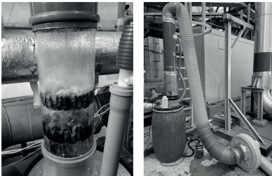
Obrázek 2) Vrstvy TRAY a celkový pohled na jednotku
