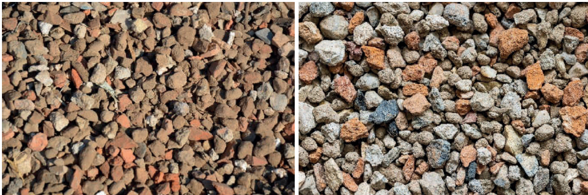
Obrázek 2) Recyklát znečištěný jemnými částicemi na povrchu zrn RK (vlevo); Recyklát bez jemných částic (vpravo).
