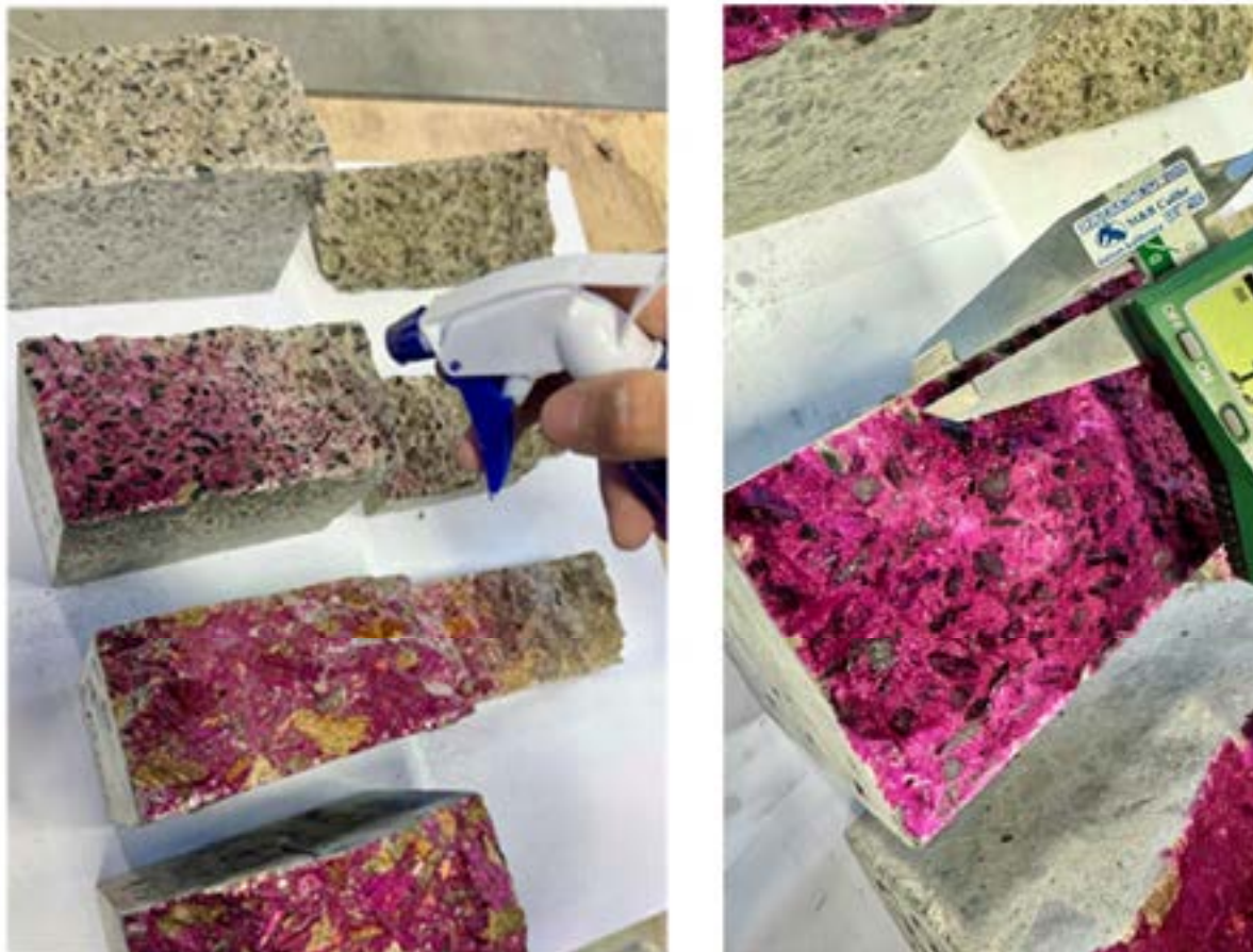
Obr. č. 2 – Průběh měření zrychlené karbonatace betonu
