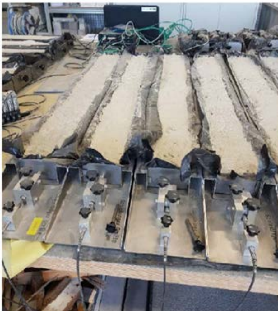
Obr. č. 1 – Měření objemových změn betonu v nerezových žlabech
